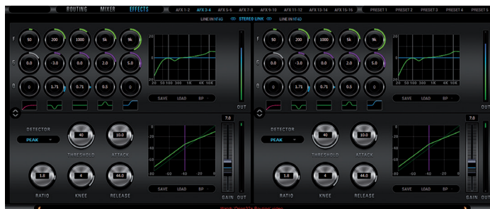
Deux des seize égaliseurs et compresseurs de l'Orion en mode stereo link.
