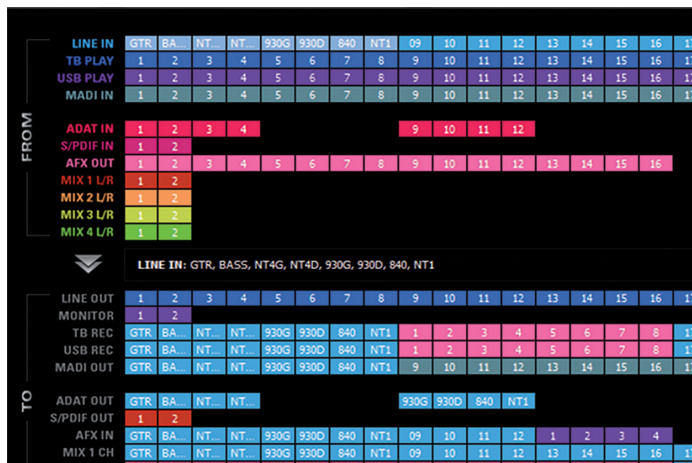
Sur cet exemple de routing, les huit premières entrées ligne sont orientées vers l'enregistrement USB ou Thunderbolt, les effets AFX et les sorties MADI et ADAT.
