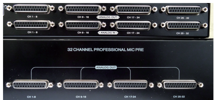
Les trente-deux entrées ou sorties analogiques se font par de classiques connecteurs SUB-D 25 au format Tascam.
